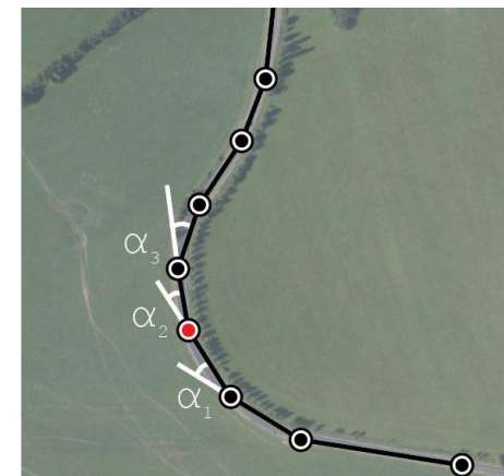
Poloměr kružnice opsané 3 sousedícím bodům
