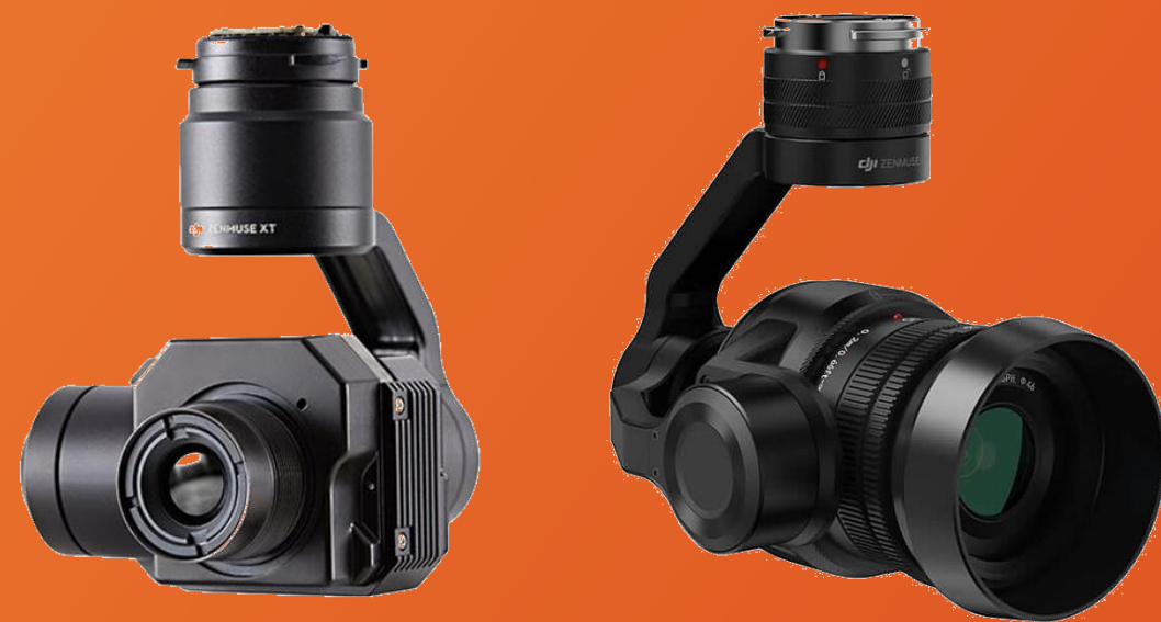
termografická kamera DJI Zenmuse XT a optická kamera DJI X5S
