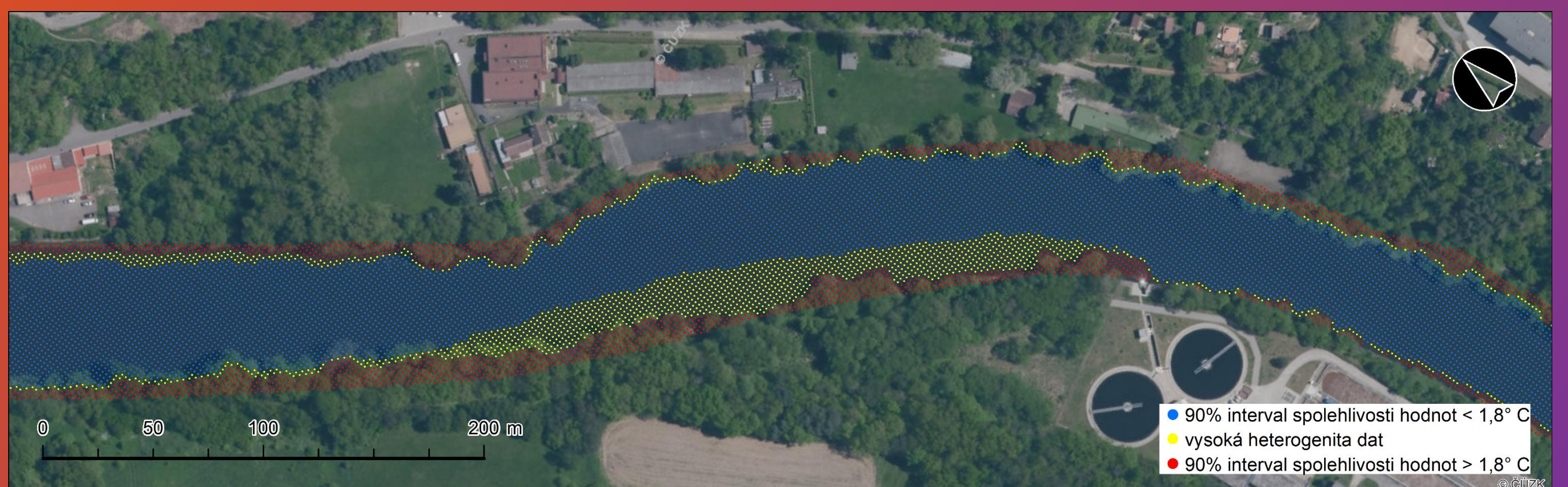
výsledky analýzy termogramu v podobě prostorové autokorelace (hotspot analýzy) – objekt vypouštění AČOV Tábor
