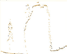
Profily bodového mračnem Vpravo je profil skalní věže, z jejíž vrstvy stromek, vlevo profil stromem, kterým prošel paprsek laseru až k povrchu. Body podrobného skenování jsou oranžovo-hnědé, body běžného skenování jsou znázorněny černě a větším symbolem. Za povšimnutí také stojí, že v podrobném skenování byly výrazně lépe nasnímány skalní věže ze stran, což je důsledek nalézávání křížem. Na levé straně věže je dokonce zachycen převis. V datech běžného skenování chybí také například terén pod stromem.
