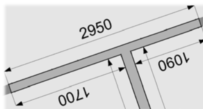
Obr. 2. Automaticky vytvořená kóta – body bez zlomu nejsou kótovány.
