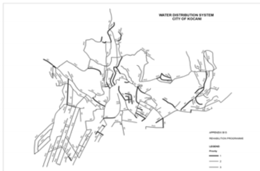
Obr. 3: Program rekonstrukce vodovodního potrubí (Kočani, 2005)
