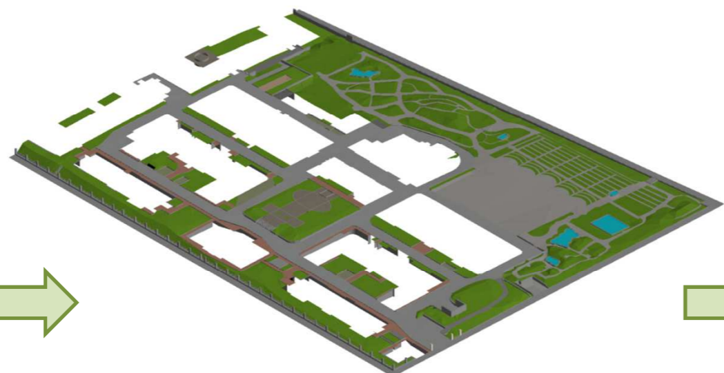
Obr. 5 TIN potažený texturami podle jednotlivých povrchů doplněný zídками a schody
