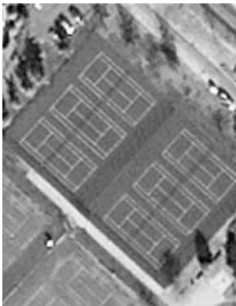
Výřezy se snímků pořízených družicí QuickBird. Vpravo: Na snímku letiště lze rozeznat jednotlivé listy rotorů vrtulníků a vrtule letadel. Vlevo: Přestože nejmenší plocha, ze které družice QuickBird zaznamená informaci činí 61 x 61 cm, je na snímku zřetelně patrná 8 cm silná čára ohraničující tenisový kurt. Tato skutečnost dobře ilustruje, že pojem „rozlišovací schopnost družicového snímku“ není totéž, co pojem „velikost pixelu družicového snímku“.
