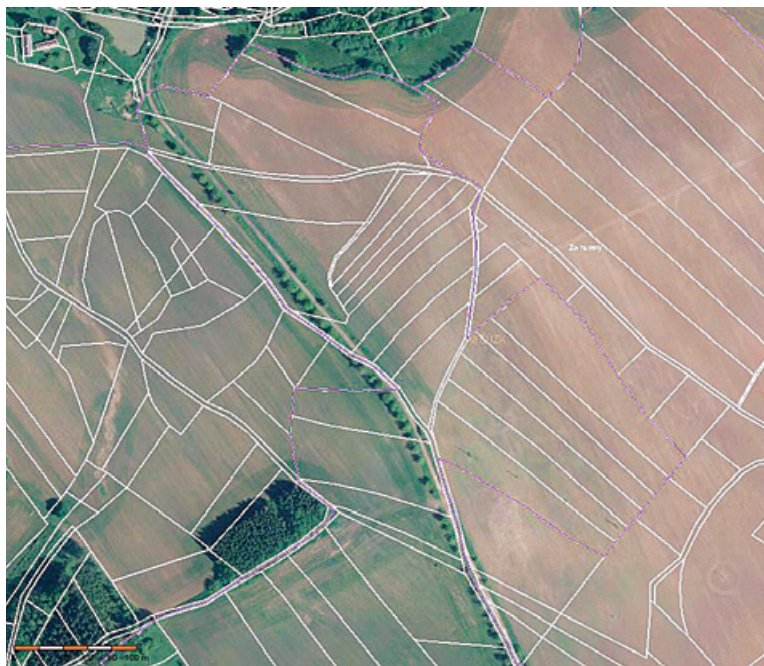
Obr. 2. Nesoulad skutečného stavu průběhu komunikací a stavu vedeného v katastru nemovitostí (k. ú. Samšina).
