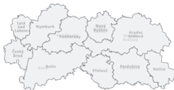
Obr. 17. Popisky polygonů. (V tematické vrstvě se není nutné omezovat na verzálky.) Světle šedě je rozmístění Maplexem, tmavě šedě ruční úprava. Popisky byly posunuty na optické středy polygonů a tak, aby Přelouč, Pardubice a Holice netvořily linii. Popisek „Lysá nad Labem“ bylo nutné celý umístit ručně.
