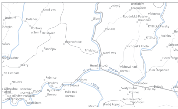
Obr. 18. Popisky vlevo vznikly se základním nastavením. Popisky vpravo mají nastavenou hodnotu řádkování (leading) na -3, váhy pro obce a vodní toky 1000 a pro silnice 900. Výsledek je o poznání uspořádanější, do ideálního stavu má však stále daleko. Je třeba upravit zalomení řádků a zlepšit rozmístění popisků, navíc v oblasti vlevo dole nebyly některé popisky umístěny vůbec. (Pro názornost jsme obce netřídili do kategorií, i když by si to data v tomto případě zasloužila.)
