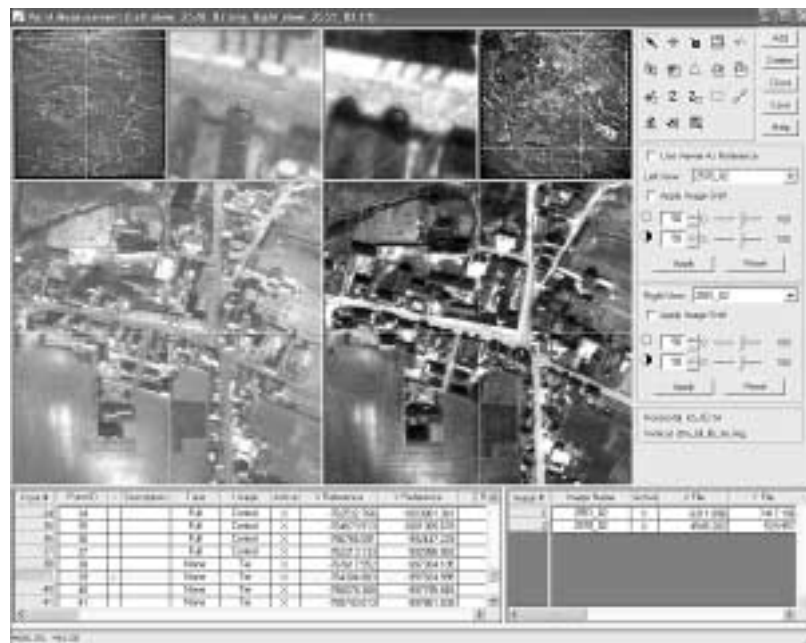
Obr. 3. Ukázka tvorby kontrolních a spojovacích bodů v prostředí Point Measurement – LPS pro ruční vyhledávání kontrolních bodů a automatickou generaci spojovacích bodů. Na obrázku náhled zpracování snímků z roku 1982 oblasti Třebenicka.
