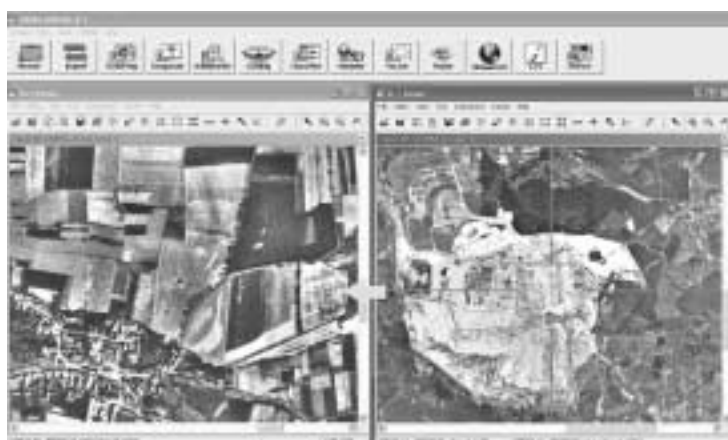
Obr. 11. Náhled na detail krajiny z roku 1938 (obrázek vlevo) s porovnáním se současným stavem (rok 1996, obrázek vpravo) v programu ERDAS IMAGINE. Oblast Radovesické výsypky na Bilinsku.
