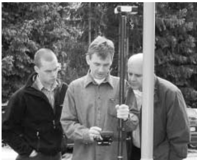
Obr. 1: Sběr GPS dat s ArcPad / GPSCorrect / Pathfinder ProXH
